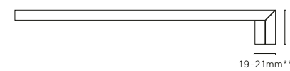
step extra thick corner . nez de marche forte épaisseur angle ecke massive stufenplatte . degrau espessurado canto
